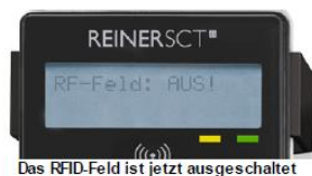
Abbildung 2 - Ausschalten des RFID Feldes des Kartenlesers
