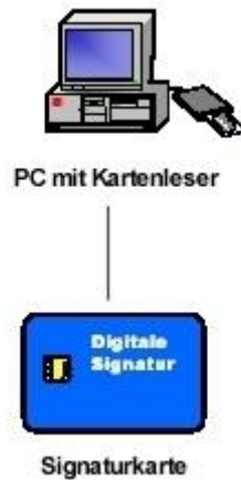
Abbildung 2 – Hardwarekomponenten für den AutoSigner
